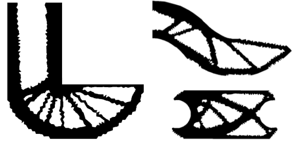
Figura 16. Resultados de Optimización Topológica lograda con la técnica de mallado.
