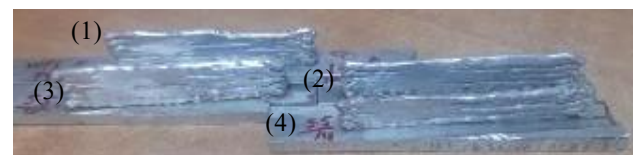
Figura 2. Depósitos tipo muro (10 capas) de Al-1100. (1) WFS:5; TS:10. (2) WFS:6; TS:14. (3) WFS:5.5; TS:10 (4) WFS:5.5. TS: 14
