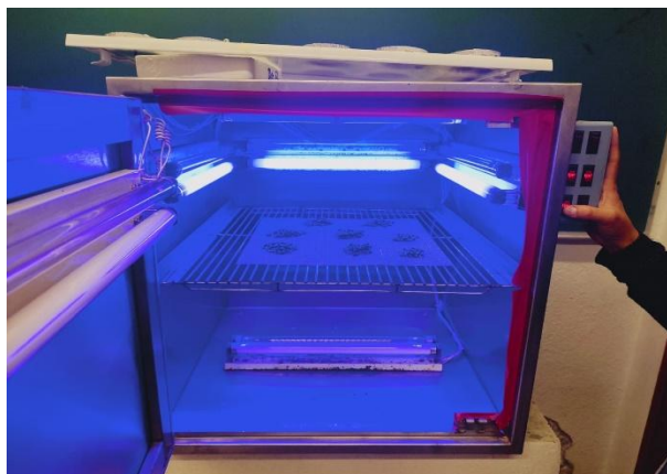
Fig. 2. Cámara de irradiación equipada con lámparas de emisión UV-C, utilizada para la estabilización y tratamiento postcosecha de frutos de chile chiltepín.
