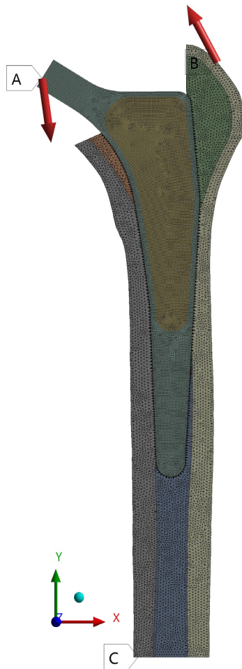
Figura 2. Modelo de elemento finito del sistema implante-fémur de un modelo homogeneizado y condiciones de frontera aplicadas.
