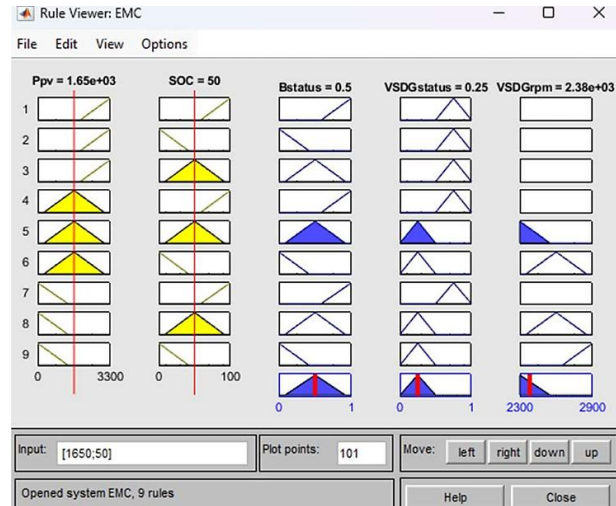
Figure 5. Visor de reglas basado en Lógica Difusa en MATLAB/Simulink (Moyo, 2024).
