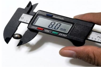
Figura 5. Perlas esféricas de acero inoxidable con un diámetro de 8.0 mm.
